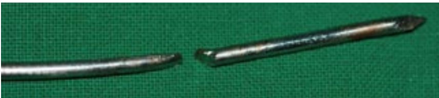
Abb. 5: Abgebohrter Zieldraht mit thermischer Verfärbung
